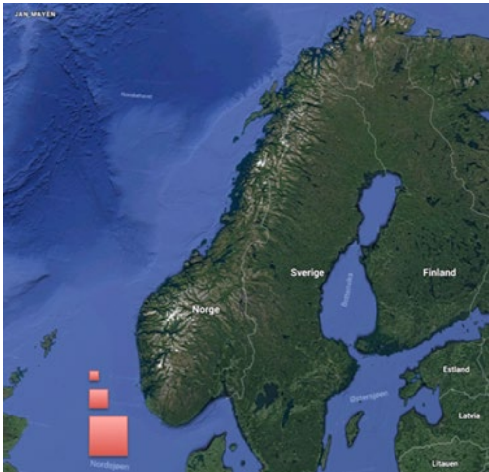
Figur 3-1: Nødvendig areal til havvindparker for å produsere tilsvarende mengde kraft som dagens vindkraft på land inkludert konsesjonsgitte prosjekt (minste området), dagens produksjon av vannkraft (midterste området) og for å erstatte all norsk gass eksport (største område). Google Maps/Tore Furevik og Finn Gunnar Nielsen, UiB
